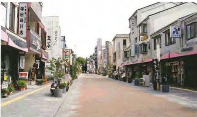
▲歩車道一体化による広場のような街路景観を形成している。
