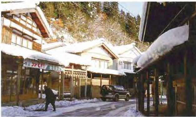
▲ 栃尾表町は約300mにわたって冬場の歩行空間を確保するための「雁木」が連なり、独特の街並みをつくりだしている。
