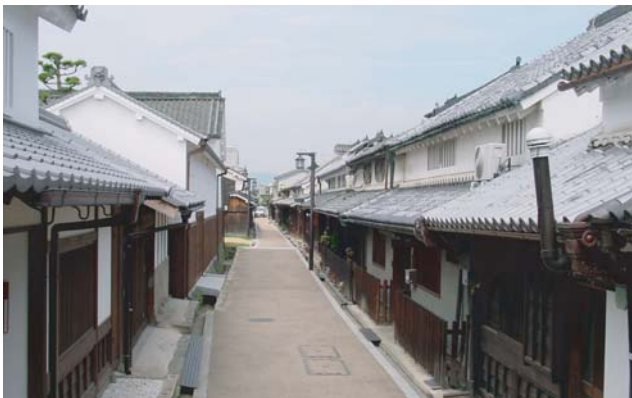
▲まちなみ環境整備事業によって電線類の地中化が図られた中町筋。
