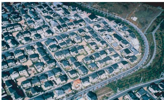
▲ 地区全景。L字型街路とポケットパークを組合せたT E Sシステムによる住宅地。
